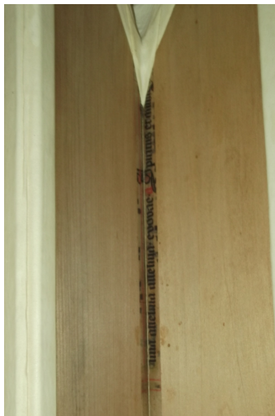
Klínový měch manětínských varhan při opravě v dílně pana Michka (vlevo) a detail pergamenových proužků spojujících části měchu (vpravo).
